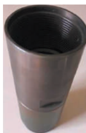
Рис. 1. Компоновка цангового кернорвача пристрою типа СКАН ПМ: а – в розібраному вигляді; б – в зібраному вигляді
