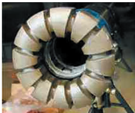
Рис. 1. Імпрегнована алмазна бурильна головка
