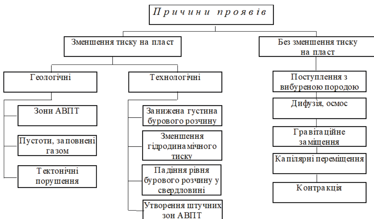
Рис. 1. Систематика причин флюїдопроявів і бурінні
