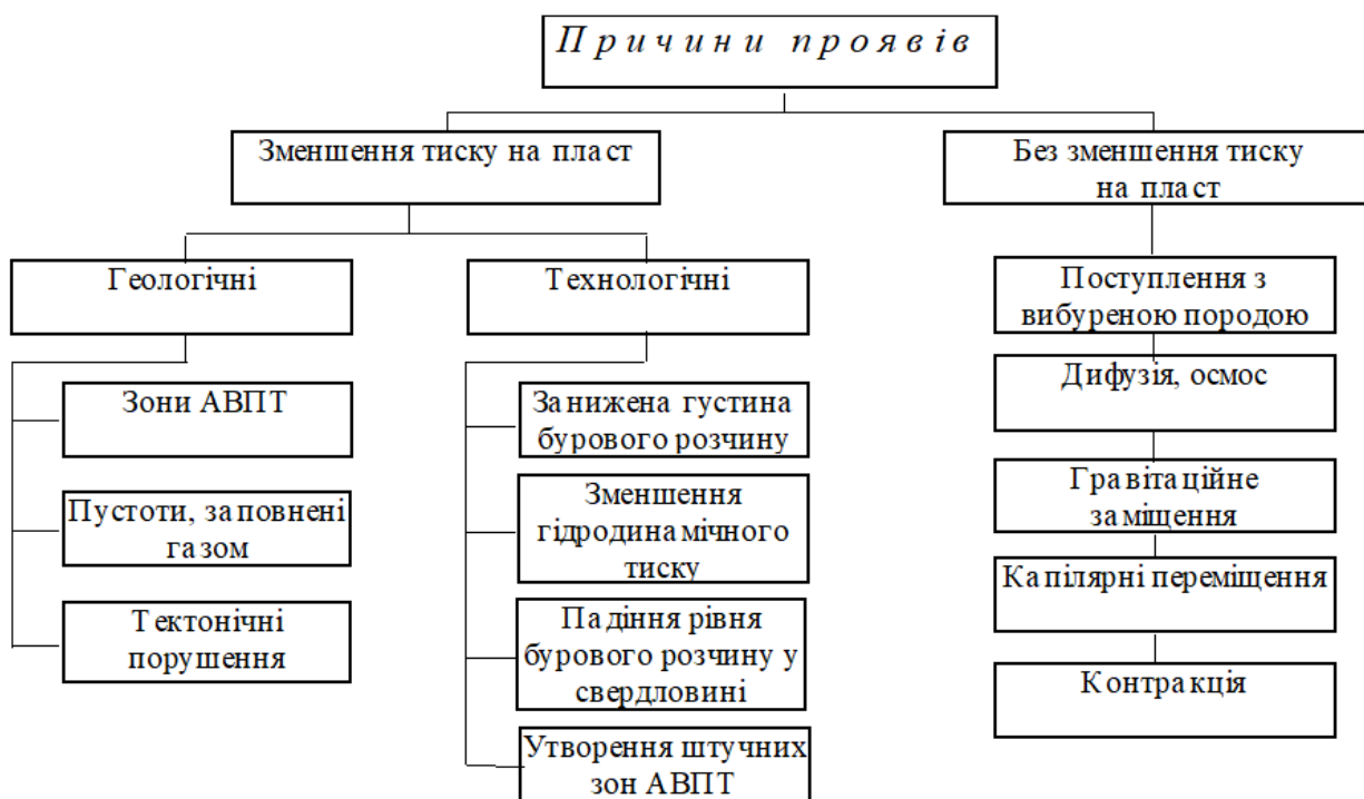
Рис. 1. Систематика причин флюїдопроявів і бурінні
