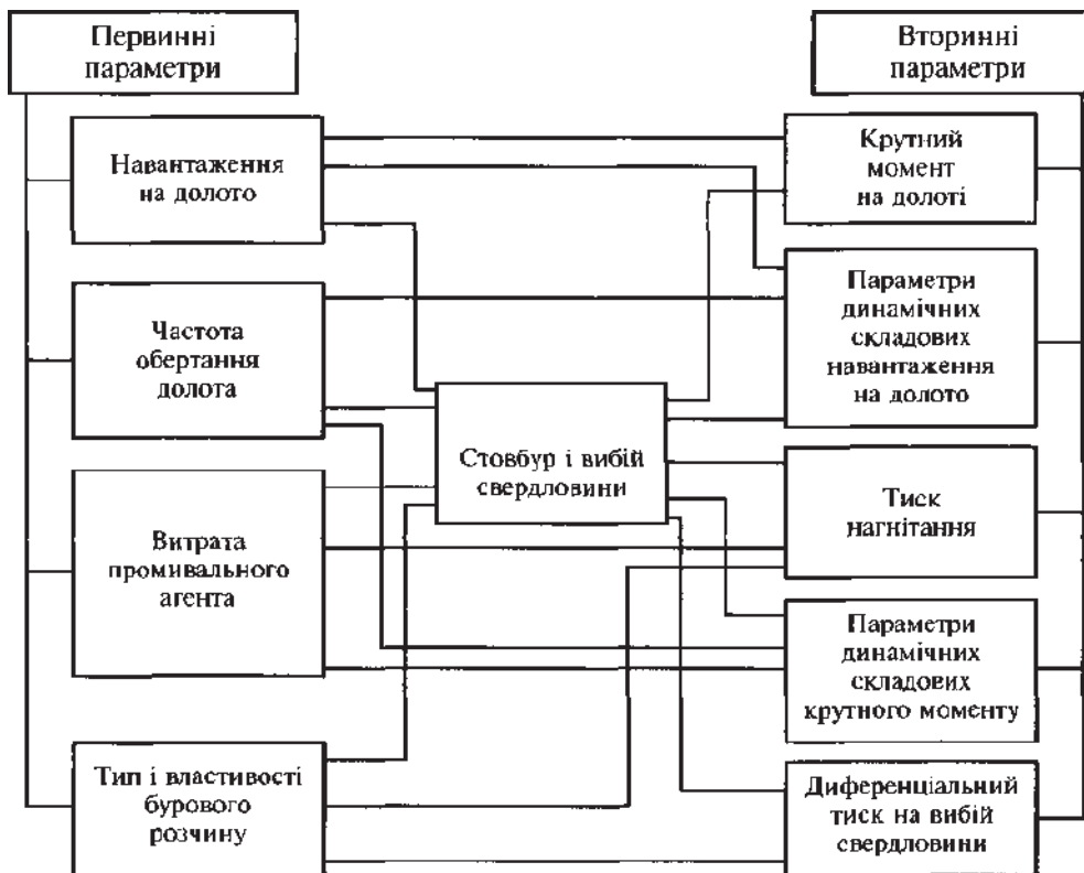
Рис. 1. Взаємозв'язок між первинними і вторинними технологічними параметрами режиму буріння
