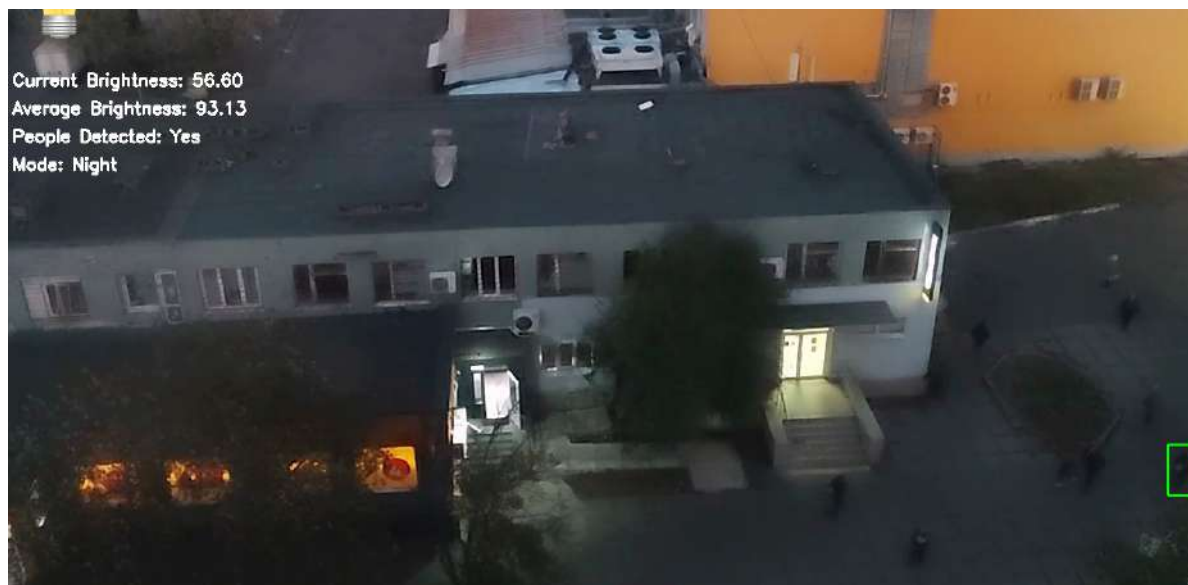
Рис. 3. Приклад роботи системи (з виявленням людини та автоматичним ввімкненням освітлення)
